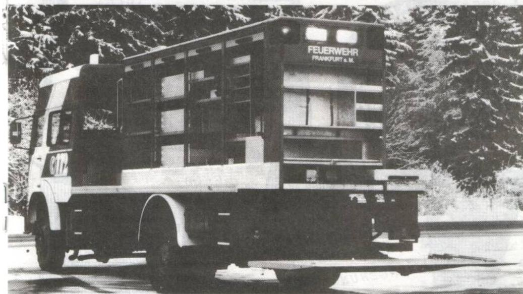
Alle Arbeiten können im Lichtraum des RW-Schiene ausgeführt werden. Die Besatzung gelangt aus der Kabine durch zwei Türen direkt auf die 55 cm breiten Laufstege rechts und links vom Geräteaufbau. Auf den Laufstegen können bei Bedarf bis zu vier Krankentragen untergebracht werden.
